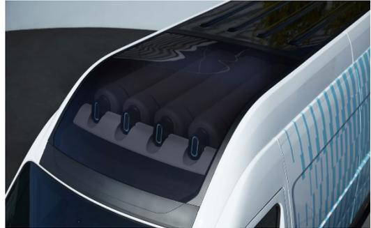
Renault master à hydrogène © Renault
