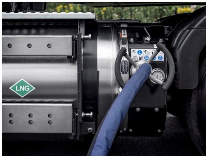
Le GNL est acheminé depuis le réservoir jusqu'au moteur via des canalisations spécifiques, avant d'être injecté à l'état gazeux.
