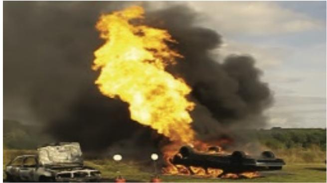
Les réservoirs de stockage du gaz naturel comprimé sont équipés d'un à plusieurs dispositifs de sécurité homologués qui libèrent le gaz en cas d'incendie et/ou d'élévation de température dépassant  $110^\circ\text{C}$ . **Le déclenchement n'est pas instantané, il faut un certain temps, de l'ordre de quelques minutes, avant que ces dispositifs ne se déclenchent.** La position du véhicule n'influe pas sur le comportement des dispositifs de sécurité ni sur les caractéristiques de la fuite de gaz.
