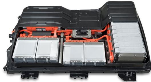
Une batterie haute tension se compose de plusieurs modules eux-mêmes composés de plusieurs cellules qui peuvent être souples, cylindriques ou prismatiques. Les modules de la batterie sont logés dans un coffrage acier ou aluminium, appelé *casing* et l'accès y est limité.
