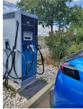
Borne recharge KEYWATT® 50kW - charge à destination ou en itinérance © IES Synergy
